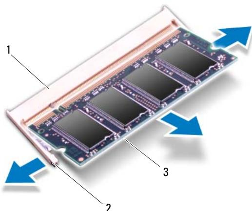
1 konektor memorijskog modula      2 spojnica za pričvršćivanje (2)
