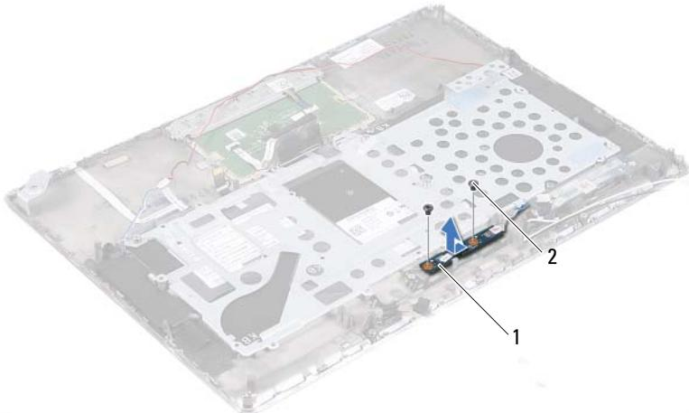
1 ploča dugmeta za uključivanje/isključivanje
